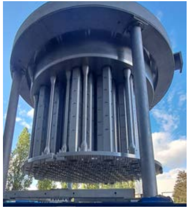
Photo d'une grappe de contrôle qui permet de contrôler la réaction en chaîne
